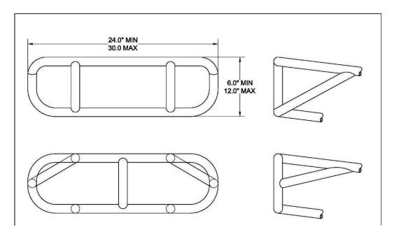
NOTE: BUMPERS MUST BE CONSTRUCTED OF 1 1/4" X 0.095 TUBING AND MAINTAIN A HEIGHT OF 18" MEASURED FROM THE GROUND TO THE MIDDLE OF THE BUMPER
